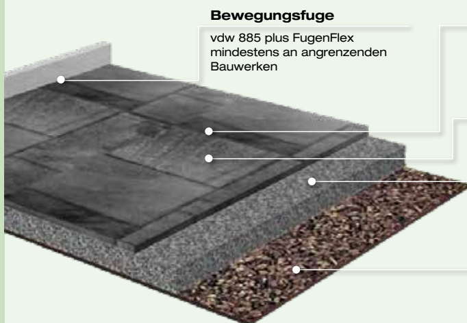
Mischbauweise mit ungebundener Bettung/Plattenbelag
